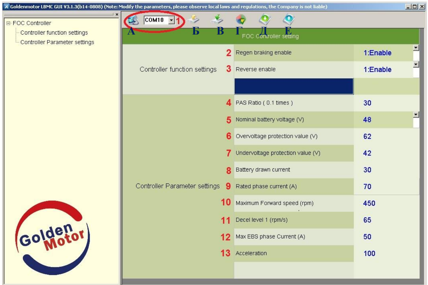
*Принскрин настроек для батареи LiFePO4 - 48
